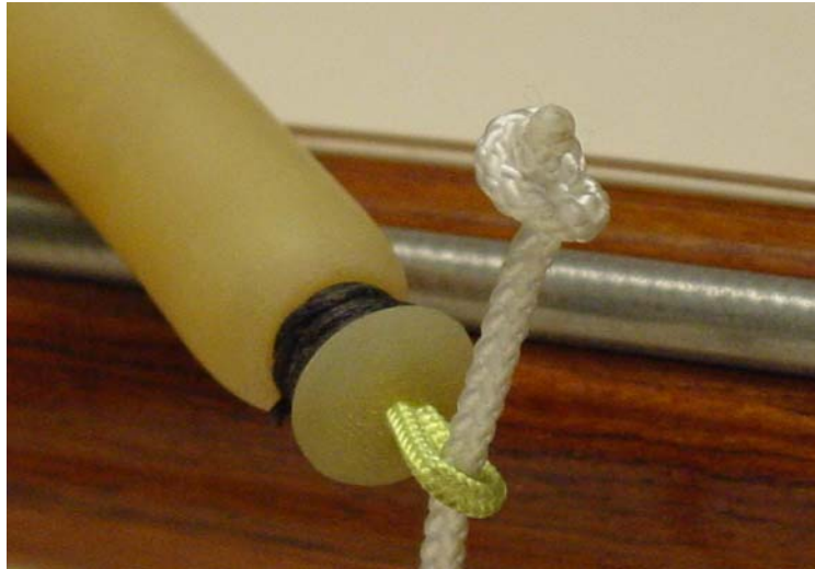
Figure 10 : Montage de la cordelette sur le brin
