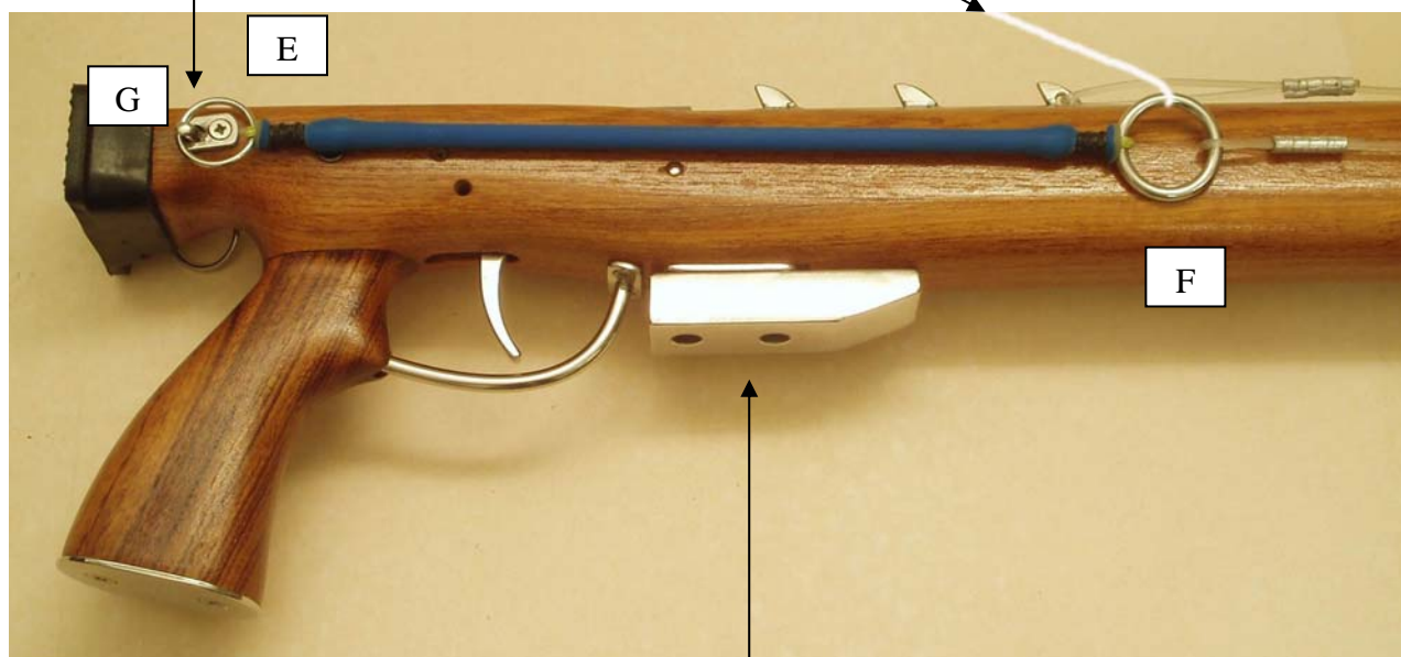
Figure 7 : Montage recommandé du breakaway
