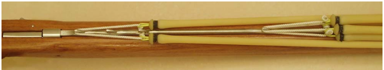
Figure 11 Exemple de mode de chargement sandows neufs. Deux sandows sur l'ergot auxiliaire, un sandow sur l'ergot le plus éloigné.
