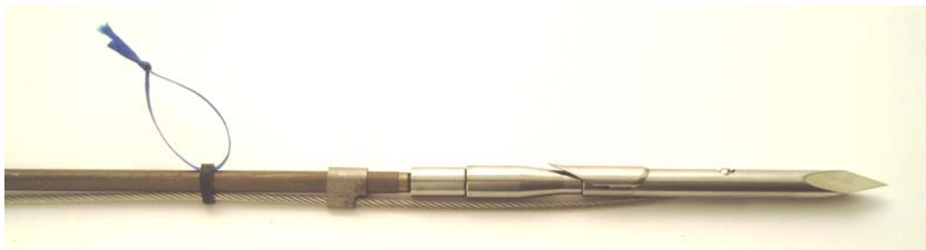
Figure 13 : Pointe Steve Alexander 4 pouces sur flèche filetée de 7,2mm de diamètre. Notez le manchon en caoutchouc qui retient le câble et donc la pointe. La petite boucle sert à écarter le manchon pour passer le câble.
